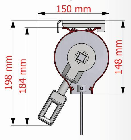
Posa Soffitto con Argano a Snodo Cardano:
